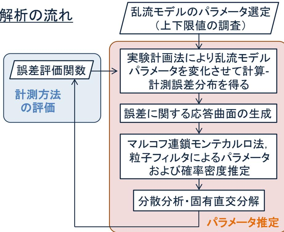
例) SST乱流モデル,  $\omega$ 方程式の崩壊項の係数(内層 $\beta_1$ , 外層 $\beta_2$ )
